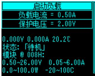
设置好负载电流和保护电压后，选择“启动负载”可启动恒流模式。
