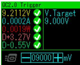
QC2.0模式下，用户通过左右键选定想要触发的电压，左边的电压电流等状态信息用于确认各项数据是否已经达到指定值。
