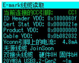
使用任意电源供电（不占用Type-C口即可，推荐使用独立供电），**打开PD通讯开关**，进入该模式，接入被测线缆悬空即显示结果。
