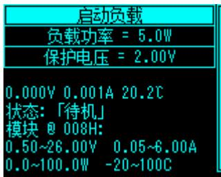
设置好负载功率和保护电压后，选择“启动负载”可启动恒功率模式。
