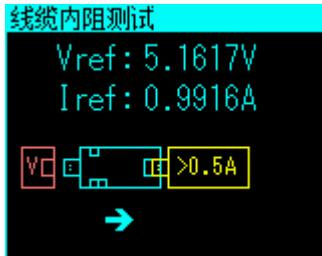
中键确认“我已接入”后从电源端拔掉表头。
