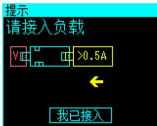
第一步通过A口接入一个电源，并在后端接入大于0.5A的恒流负载。
