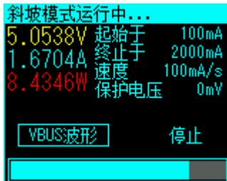
确认后，进入运行界面，左边显示当前的电流电压读数，右边显示设置的参数。
