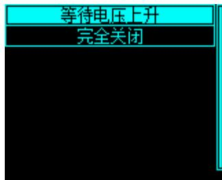
设置在被测设备电压低于所设置的保护电压时负载控制器的行为。若选择“等待电压上升”，则负载不会完全关闭，当电压回升到保护电压之上，或者插入新的被测设备时，负载将自动重启。若选择“完全关闭”，则检测到截断时，完全关闭负载，负载不会自动重启。
