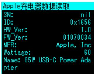
通过C-C线缆连接被测苹果充电器与表头(PD通讯开关需要打开)。
