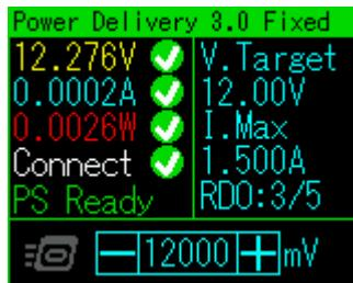
固定电压模式下，用户可通过左右键请求相应的电压。
